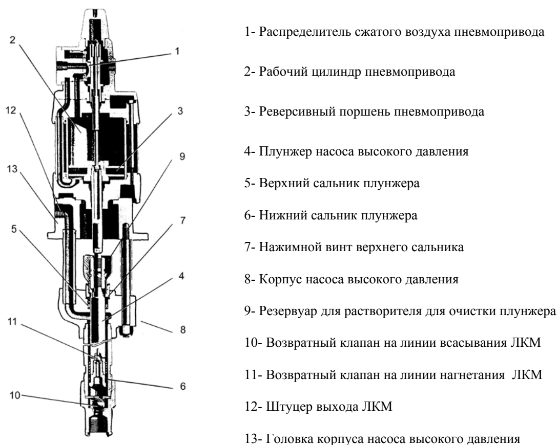
Рис. 5 Принципиальное устройство насоса высокого давления с пневмоприводом
